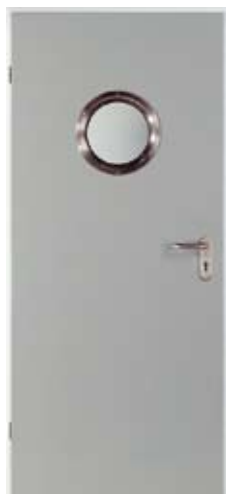
Vrata ZK/OIT okrogla zasteklitev Ø 300 mm alu-zasteklitveni okvir, eloksiran v naravnem tonu (E//EV1), po naročilu iz legiranega jekla, krtačeno (slika)
