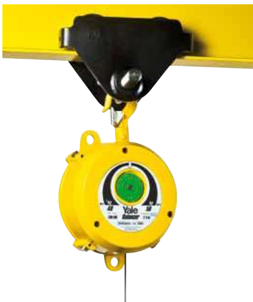
Öse für Sicherheitskette Nach DIN 15112 muss der Balancer mit einer zusätzlichen Sicherheitskette befestigt werden.
