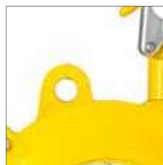
Öse für Sicherheitskette Nach DIN 15112 muss der Balancer mit einer zusätzlichen Sicherheitskette befestigt werden.
