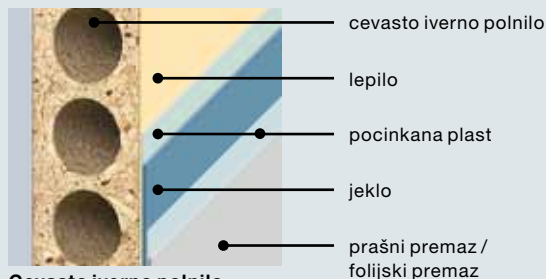
Cevasto iverno polnilo (standardno)
