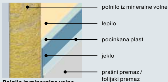
Polnilo iz mineralne volne (po naročilu) za boljšo toplotno izolacijo
