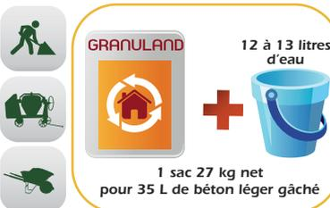
Incorporer 1 sac entier de 35 L dans la bétonnière et ajouter l'eau correspondante (12 à 13 litres/sac). Laisser malaxer 3 à 4 min jusqu'à l'obtention d'une pâte homogène non liquide (le mélange doit être utilisé dans les 35 min qui suivent sa préparation). Ne pas ajouter d'autres composants
