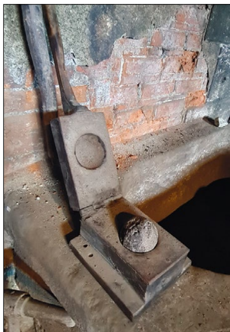
Preprosta naprava za izdelavo glinenih krogel, s katerimi so zaprli odprtino za iztok železa. Izdelovali so jih otroci. Kroglo so nabodli na posebno dolgo orodje in jo porinili v odprtino, da so luknjo zaprli. Foto: Andrej Bogataj
