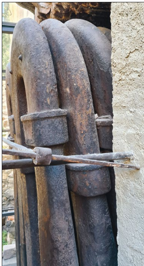
Delno ohranjena naprava za ogrevanje vpihovalnega zraka. Zunanje stene so odstranjene. Foto: Andrej Bogataj
