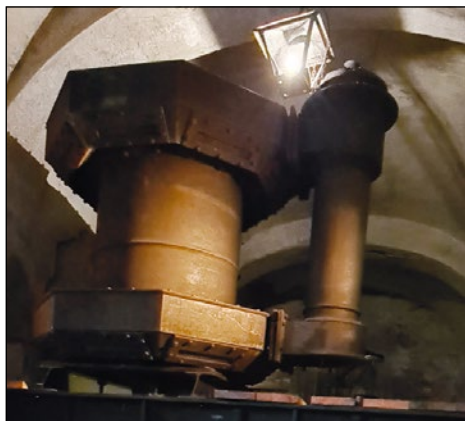
Batni meh iz Vordernberga. Foto: Andrej Bogataj. Vir: Muzej Radwerk IV.
