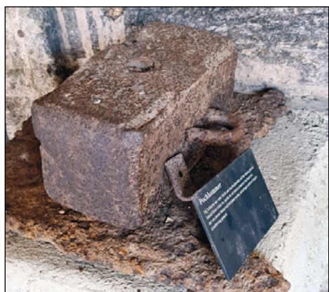
Kladivo za razbijanje ohlajenih plošč tekočega železa ali izpuščene in strnjene žindre, ki so jo izpuščali iz peči. Z verigo je bilo kladivo pripeto na vzvod, ki so ga dvignili pod strop in spustili na ploščo, da se je razbila. Foto: Andrej Bogataj
