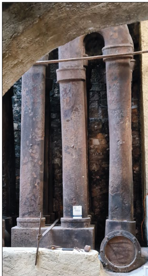
Delno ohranjena naprava za ogrevanje vpihovalnega zraka. Zunanje stene so odstranjene. Foto: Andrej Bogataj
