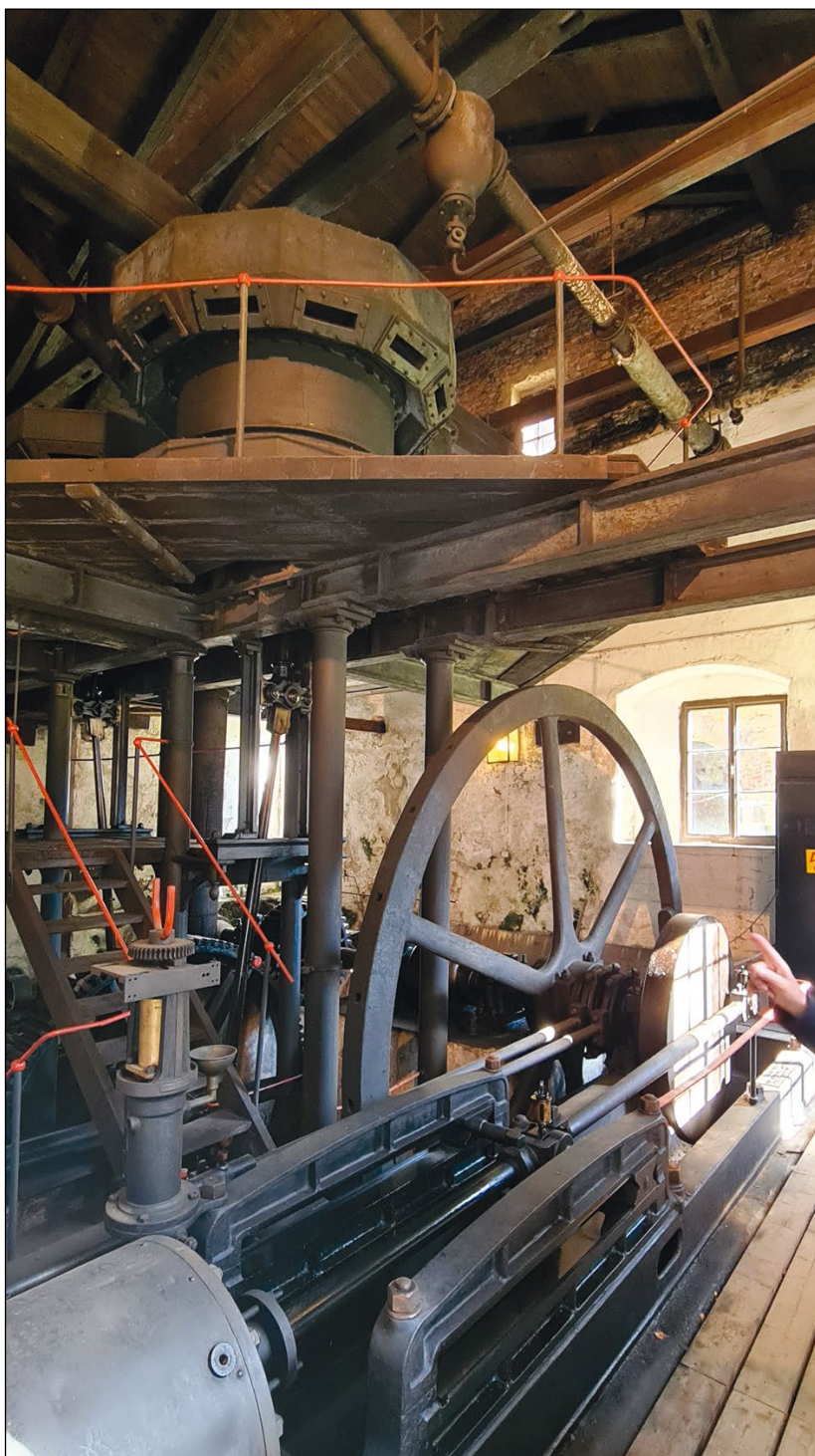
Delujoči batni meh v obratu Radwerk III. Foto: Andrej Bogataj
