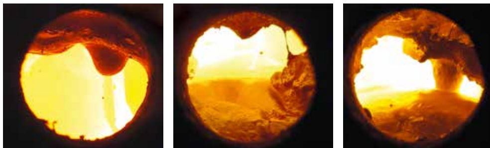
Slika 14. Kaplja žlindre ali staljene stene peči na zgornji strani odprtine šobe (levo), brbotanje taline na spodnji strani šobe (na sredini) in spojena kaplja z zgornje strani in taline s spodnje strani (desno). Foto: Stane Zgaga
