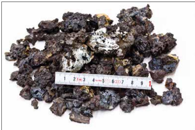
Slika 22. Pri žaganju se je volk razletel, zato je bil prerez izveden na manjših kosih.
