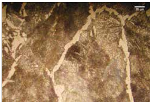
Slika 23. Metalografska analiza kovnega železa iz volka, pridobljenega pri taljenju 2018 v Stari Fužini, nakazuje področja, kjer so prevladujoča zrna železa (ferita) z malo perlita na kristalnih mejah (levo) in področja s prevladujočo perlitno strukturo ter feritom na kristalnih mejah (desno). Foto: Barbara Bertoncelej
