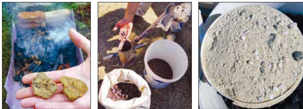
Slika 16. Praženje rude (levo), drobljenje pražene rude v možnarju (na sredini) in drobljen kremen (desno).
