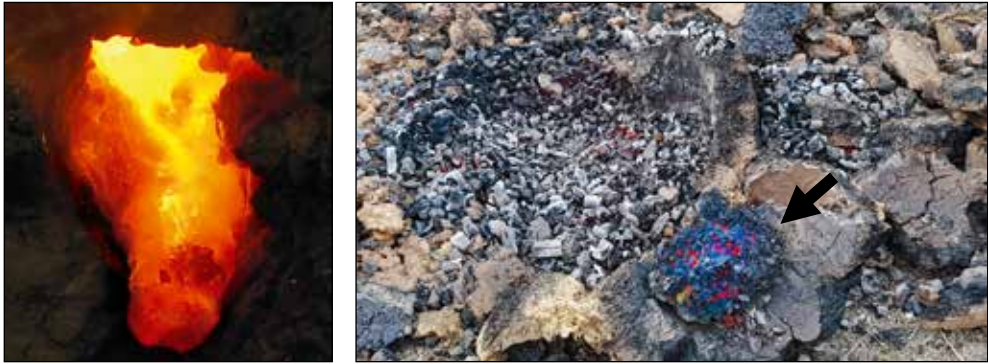
Slika 18. Izpuščanje tekoče žilindre (levo) in razdrta peč z volkom (desno).
