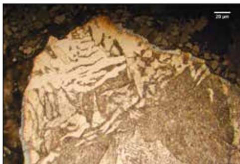
Slika 24. Metalografska analiza kovnega železa iz volka, pridobljenega pri taljenju 2017 v Železnikih. Leva slika nakazuje področje, kjer je prevladujoča feritna struktura s številnimi vključki žilindre. Desna slika nakazuje področja s prevladujočo perlitno strukturo, na meji z žilindro pa je prišlo do razogličenja in se nahaja ferit. Foto: Barbara Bertoncelej
