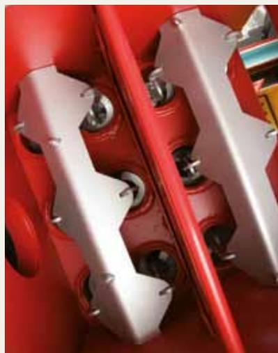
Système de nettoyage automatique des tubes de fumées.
