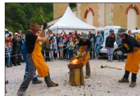
Slika 13. Taljenje v Tržiču – izvlek žarečega volka iz peči, kjer od njega kaplja tekoča žilindra (zgoraj). Kovanje na nakovalu najprej poteka z večjimi lesenimi kladivi (na sredini) in nato sledi še močno kovanje s kovinskimi kladivi (levo spodaj). Volk je po kovanju že delno preoblikovan v "štruco" z ravnimi stranicami (desno spodaj). Foto: Simon Benedičič
