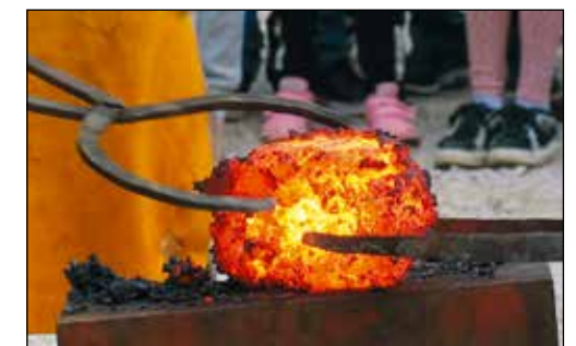
Slika 13. Taljenje v Tržiču – izvlek žarečega volka iz peči, kjer od njega kaplja tekoča žilindra (zgoraj). Kovanje na nakovalu najprej poteka z večjimi lesenimi kladivi (na sredini) in nato sledi še močno kovanje s kovinskimi kladivi (levo spodaj). Volk je po kovanju že delno preoblikovan v "štruco" z ravnimi stranicami (desno spodaj). Foto: Simon Benedičič
