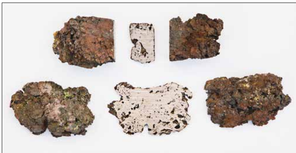
Slika 7. Polovici volka s sredinski prerezom iz peči z dnom v ravnini tal (zgoraj) in iz peči s poglobljenim dnom (spodaj). Foto: Andrej Bogataj
