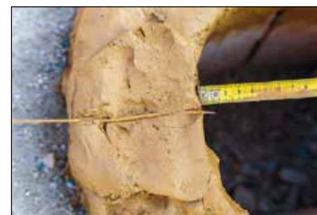
Slika 5. Prikaz vgradnje termočlena v steno peči. Foto: Simon Benedičič
