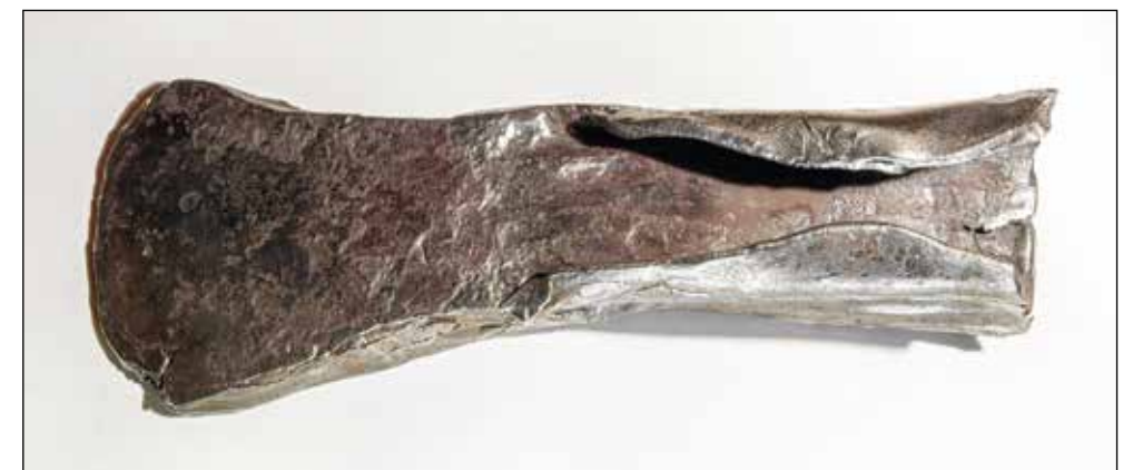
Slika 16. Skica železnodobne plavutaste sekire in njena replika (m = 895 g) skovana iz pravokotnega ingota (m = 984 g). Skica in foto: Bojan Rihtaršič
