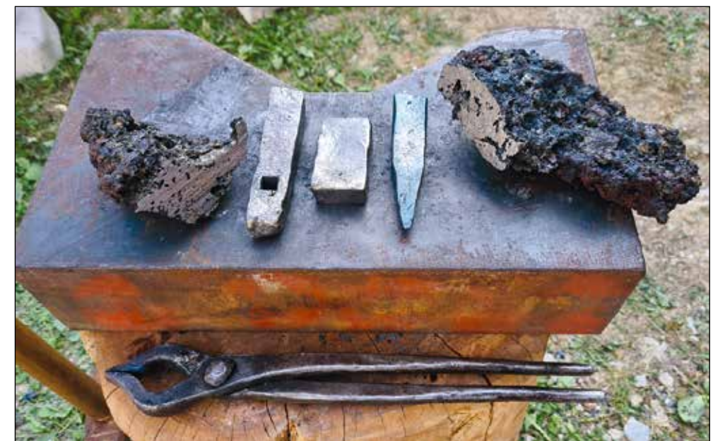
Slika 3. Polovica volka iz rude granulacije < 1,6 mm in ingota iz odrezane polovice volka (levo) in volk iz rude granulacije med 1,6 mm in 4 mm ter ingot iz odrezanega konca (desno).
