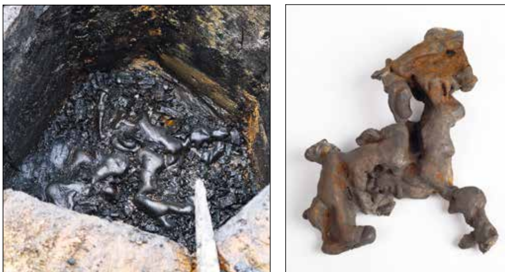
Slika 8. Ostanek tekoče žlindre na dnu jaška za žlindro, ki očiščen razkriva podobo konja v galopu. Konica na desni strani jame za žlindo ponazarja smer vpiha zraka. Foto: Andrej Bogataj
