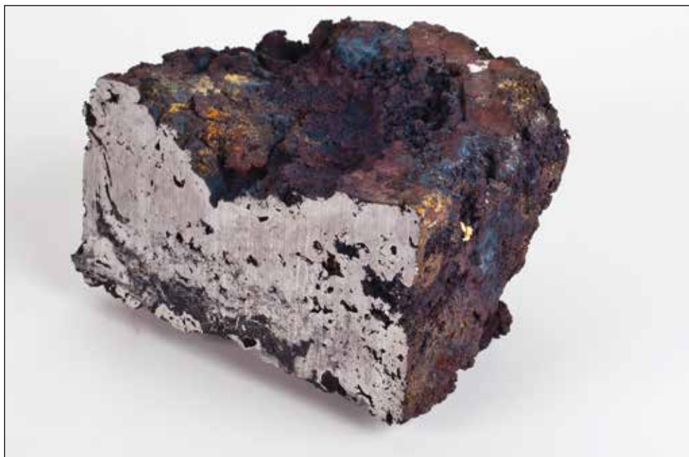
Slika 14. Prerez volka s taljenja v Stari Fužini leta 2019 brez kovanja po taljenju izkazuje močno porozno strukturo z vključki neizgorelega oglja na spodnji strani (levo) in prerez volka močno kovanega takoj po izvleku iz peči v Tržiču leta 2022 (desno). Prerez kovanega volka iz Tržiča je manj porozen in je po izgledu med surovim volkom ter ingotom. Foto: Andrej Bogataj
