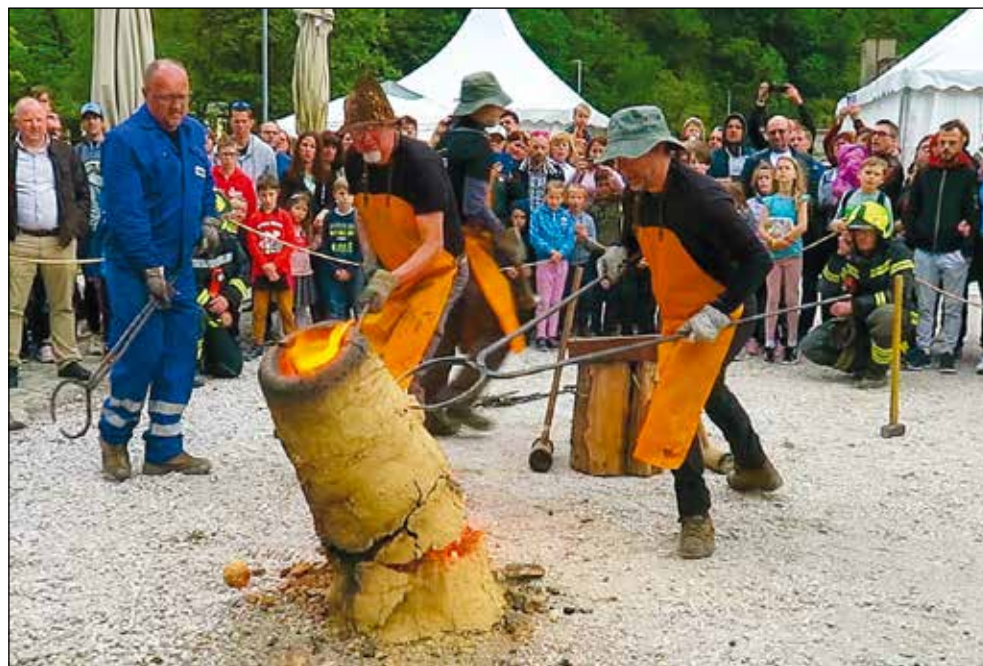
Slika 12. Taljenje v Tržiču – sekanje peči po obodu na višini šobe (zgoraj) in podiranje peči (spodaj). Foto: Simon Benedičič
