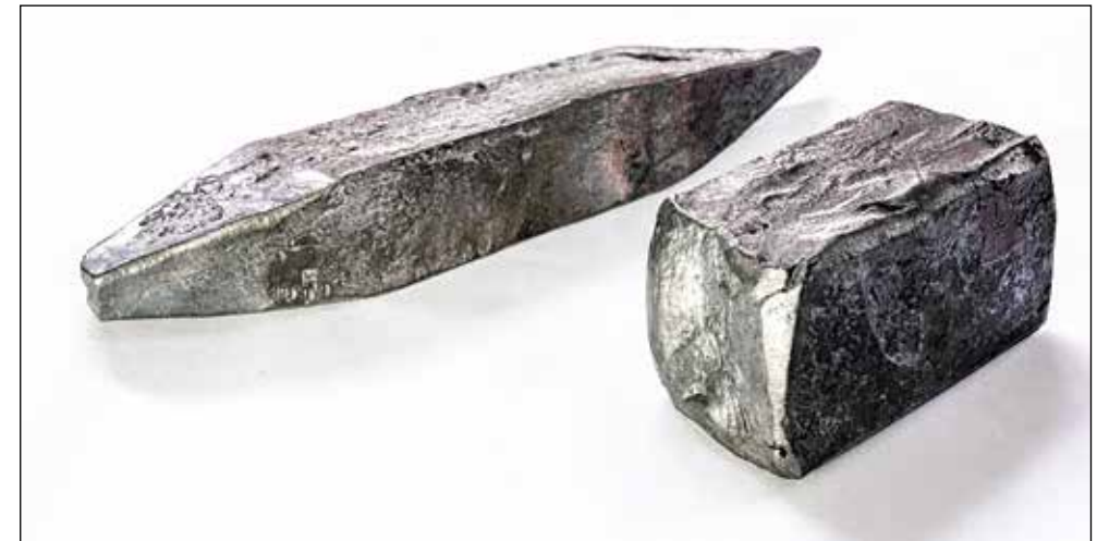
Slika 15. Podolgovati ingot z zaključkom v konico (m = 901 g) in pravokotni ingot (m = 984 g) skovana iz četrtink volka iz Tržiča. Foto: Bojan Rihtaršič
