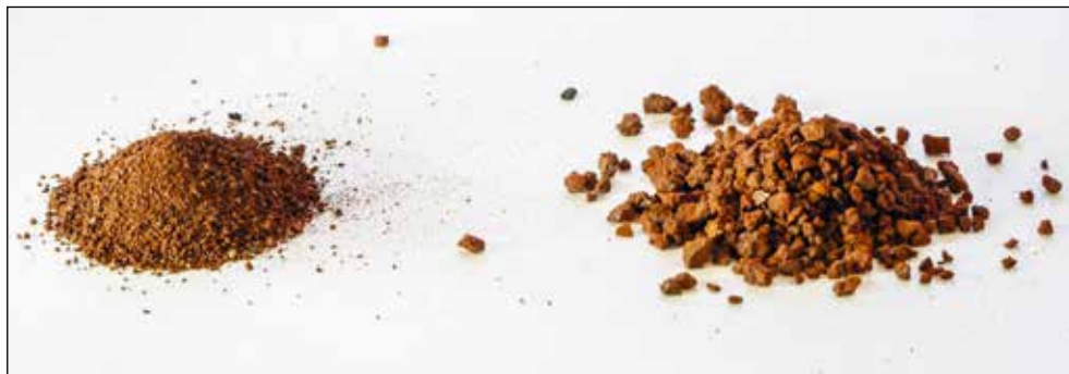
Slika 1. Zrna drobljene, pražene rude granulacije <1,6 mm in granulacije zrn od 1,6 mm do 4 mm. Foto: Bojan Rihtaršič
