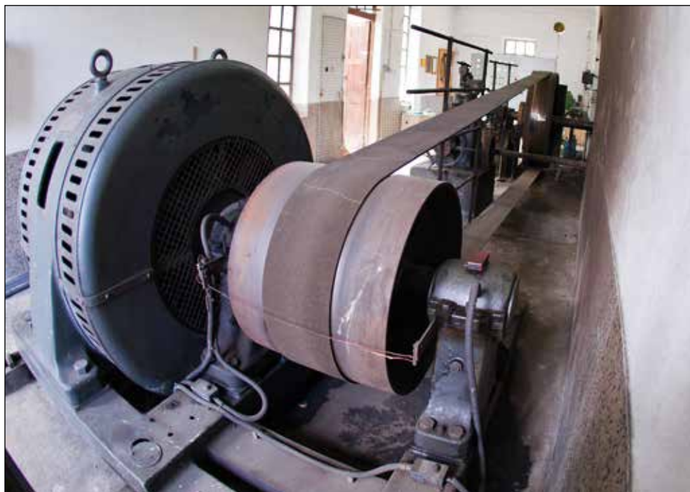
Pogonski jermen, ki je moč prenašal z vztrajnika na generator. Foto: Andrej Bogataj
