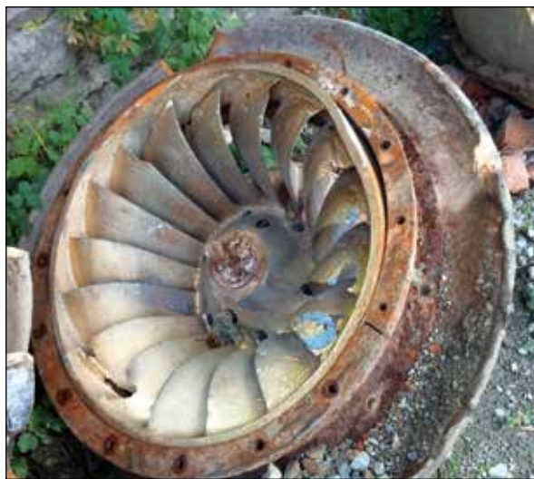
Turbina po odstranitvi iz vodnega stopa. Vidi se obraba nekaterih lopatic. Foto: Andrej Bogataj
