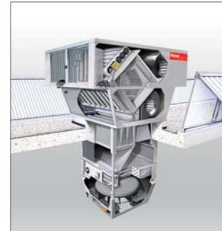
Naprave tipa RoofVent® so strešne prezračevalne naprave za dovajanje zunanjega in odvajanje odpadnega zraka. Dovajan zrak ogrevajo in hladijo s pomočjo integriranih izmenjevalcev toplote, z vračanjem toplote in obratovanjem z mešanjem zraka varčujejo z energijo, poleg tega pa so lahko opremljene tudi z decentraliziranim pridobivanjem toplote ali hladu.
