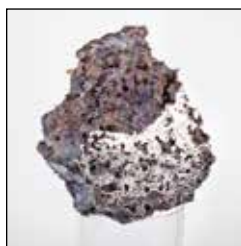
Slika 11. Volk iz limonitne rude – bobovec. Levo: mesto prereza, na sredini: prerezna površina večje polovice volka (6,10 kg), desno: prerezna površina manjše polovice volka (1,15 kg). Foto: A. Bogataj
