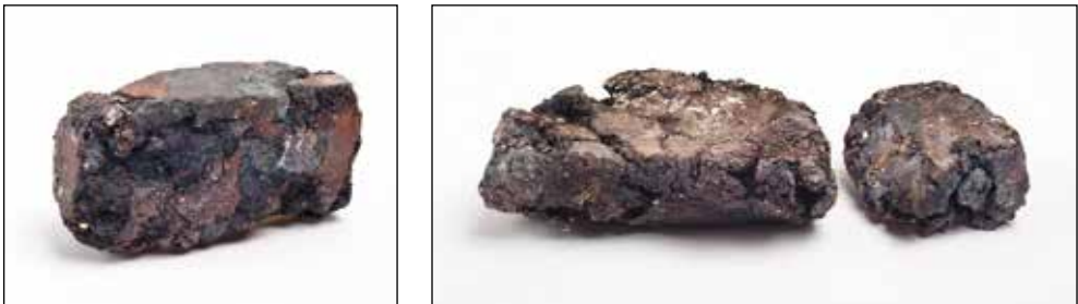
Slika 15. Ingot po kovanju volka, ponovno segretega v kovaškem ognjišču. Levo: 31 x 43 x 85 mm velik in 0,61 kg težek kos iz volka iz bobovca. Desno: volk iz magnetitne rude je pri kovanju razpadel na več manjših kosov, kjer sta največja dva dimenzij 35 x 92 x 143 mm in mase 1,81 kg ter 36 x 58 x 67 mm in mase 0,56 kg. Foto: A. Bogataj
