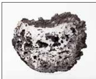
Slika 12. Volk iz magnetitne rude. Levo: mesto prereza, na sredini: prerezna površina večje polovice volka (5 kg), desno: prerezna površina manjše polovice volka (2,35 kg). Foto: A. Bogataj
