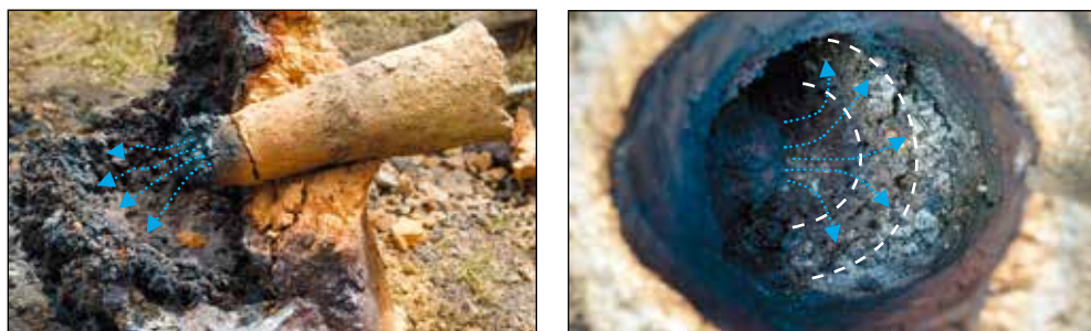
Slika 7. Volk je lociran pod šobo (levo). Na zgornji strani volka se nahaja "koralna" struktura, ki je polkrožno razporejena okoli šobe (desno). Foto: S. Benedičič
