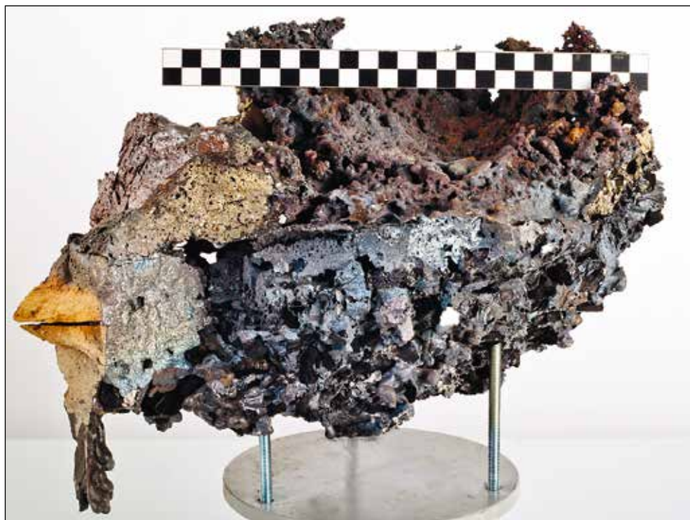
Slika 7. Volk je lociran pod šobo (levo). Na zgornji strani volka se nahaja "koralna" struktura, ki je polkrožno razporejena okoli šobe (desno). Foto: S. Benedičič
