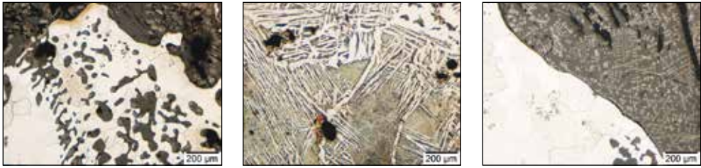
Slika 14. Metalografske slike volka iz magnetitne rude: vzorec iz spodnjega dela volka (levo), vzorec iz sredine volka (srednja fotografija) in vzorec iz vrha volka (desno). Foto: J. Burja
