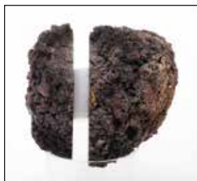
Slika 12. Volk iz magnetitne rude. Levo: mesto prereza, na sredini: prerezna površina večje polovice volka (5 kg), desno: prerezna površina manjše polovice volka (2,35 kg). Foto: A. Bogataj
