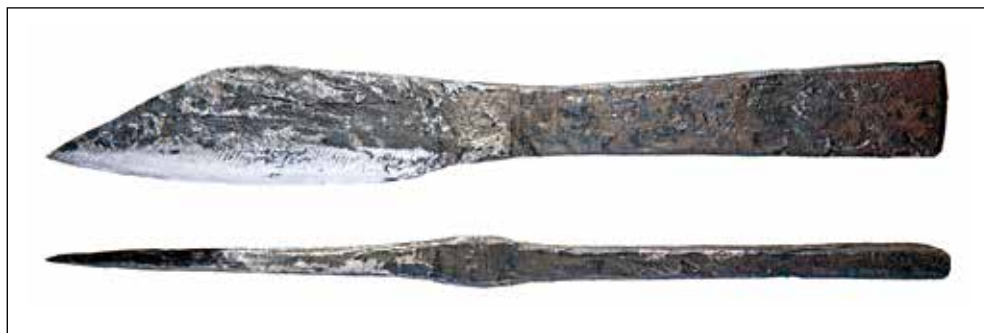
Slika 20. Replika noža iz rimskega obdobja, narejena iz kovnega železa, pridobljenega iz taljenja rude bobovec. Masa noža je 0,11 kg. Foto: B. Rihtaršič
