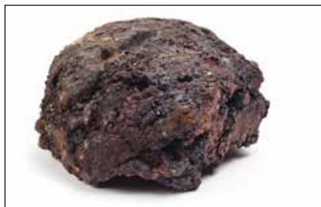
Slika 18. Levo: dobro očiščen 5,5-kilogramski volk dimenzij 86 x 136 x 138 mm taljenja na Češnjici v Železnikih. Desno: prerez dveh četrtin volka taljenja na Češnjici v Železnikih. Foto: A. Bogataj.
