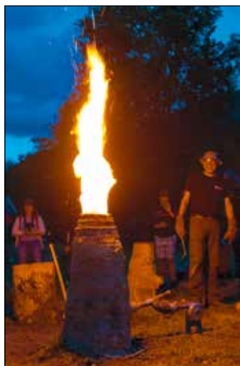
Slika 9. Leva slika: segrevanje večje peči pred izvlekom volka. Desna slika: kovanje volka z lesenimi bati na tnalu. Foto: S. Benedičič
