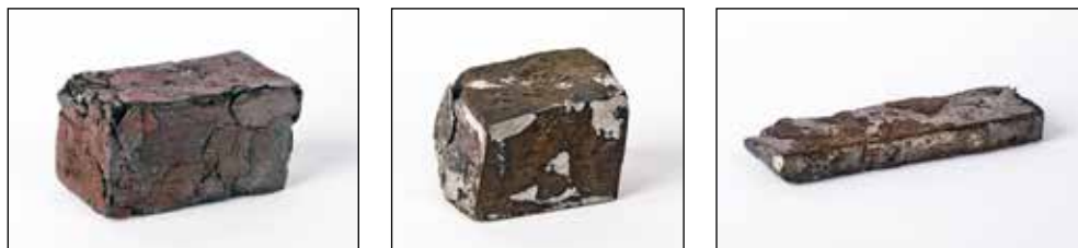
Slika 19. Levo: Kos kovnega železa iz volka iz Stare Fužine, kjer je bila uporabljena ruda bobovec. Iz kosa mase 0,61 kg smo po 25 gretjih ter kovanjih dobili kos mase 0,19 kg. Na sredini: kos kovnega železa iz volka iz Stare Fužine, kjer je bila uporabljena ruda magnetit. Iz kosa mase 0,56 kg smo po 24 gretjih ter kovanjih dobili kos mase 0,21 kg. Desno: kos kovnega železa iz četrtine volka s Češnjice v Železnikih, kjer je bila uporabljena ruda bobovec. Iz kosa volka mase 1,11 kg smo po 31 gretjih ter kovanjih dobili kos mase 0,39 kg. Foto: A. Bogataj
