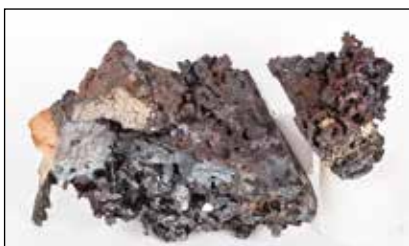
Slika 11. Volk iz limonitne rude – bobovec. Levo: mesto prereza, na sredini: prerezna površina večje polovice volka (6,10 kg), desno: prerezna površina manjše polovice volka (1,15 kg). Foto: A. Bogataj
