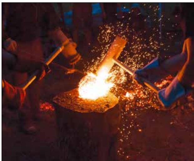
Slika 9. Leva slika: segrevanje večje peči pred izvlekom volka. Desna slika: kovanje volka z lesenimi bati na tnalu. Foto: S. Benedičič
