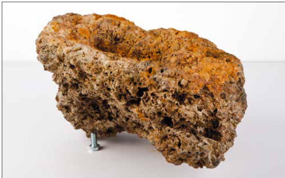
Slika 3. Volk z železnodobnega najdišča Štalca dimenzij 30 x 22 x 18 cm ter mase 9,65 kg. Vir in foto: A. Bogataj. Zgoraj je vidna vdolbina, ki je verjetno nastala kot posledica vpihovanja zraka. Spodaj je močno porozna struktura, kjer so v žilindri vidni sledovi odtisov neizgorelega oglja.
