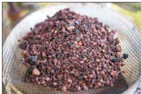
Slika 1. Pri praženju bobovca se izloča vodna para (levo). Masa rude bobovec se je po praženju znižala s 30 kg na 25,8 kg ter se je obarvala rdeče in postala krhka. Praženo rudo smo nadalje drobili v možnarju in sejali na velikost premera < 4 mm (desno). Foto: S. Benedičič
