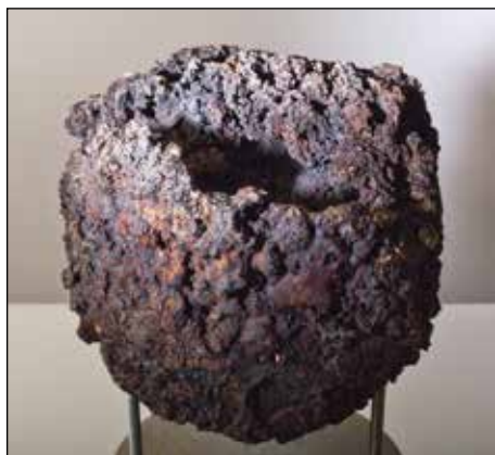
Slika 10. Leva slika: 8,35-kilogramski volk s polkrožno vdolbino na vrhu, ki je posledica smeri vpiha. Foto: A. Bogataj. Desna slika: Tudi pri večji peči je bila stena v neposredni bližini šobe in nad šobo najbolj pretaljena. Foto: S. Benedičič
