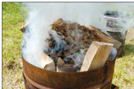
Slika 1. Pri praženju bobovca se izloča vodna para (levo). Masa rude bobovec se je po praženju znižala s 30 kg na 25,8 kg ter se je obarvala rdeče in postala krhka. Praženo rudo smo nadalje drobili v možnarju in sejali na velikost premera < 4 mm (desno). Foto: S. Benedičič
