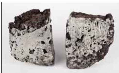
Slika 18. Levo: dobro očiščen 5,5-kilogramski volk dimenzij 86 x 136 x 138 mm taljenja na Češnjici v Železnikih. Desno: prerez dveh četrtin volka taljenja na Češnjici v Železnikih. Foto: A. Bogataj.
