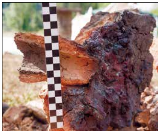
Slika 10. Leva slika: 8,35-kilogramski volk s polkrožno vdolbino na vrhu, ki je posledica smeri vpiha. Foto: A. Bogataj. Desna slika: Tudi pri večji peči je bila stena v neposredni bližini šobe in nad šobo najbolj pretaljena. Foto: S. Benedičič
