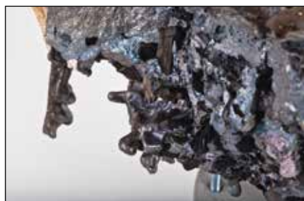
Slika 8. Slika zgoraj: volk. Na levi strani volka so ostanki stene peči, spodaj se volk meša z ostanki oglja ter žlindre. Na vrhu ima volk polkrožno koralno strukturo premera 20 cm. Slika spodaj levo: tlorisni pogled na porozno "koralno" strukturo. Slika spodaj desno: ostanki žlindre, pomešane z ogljem. Foto: A. Bogataj
