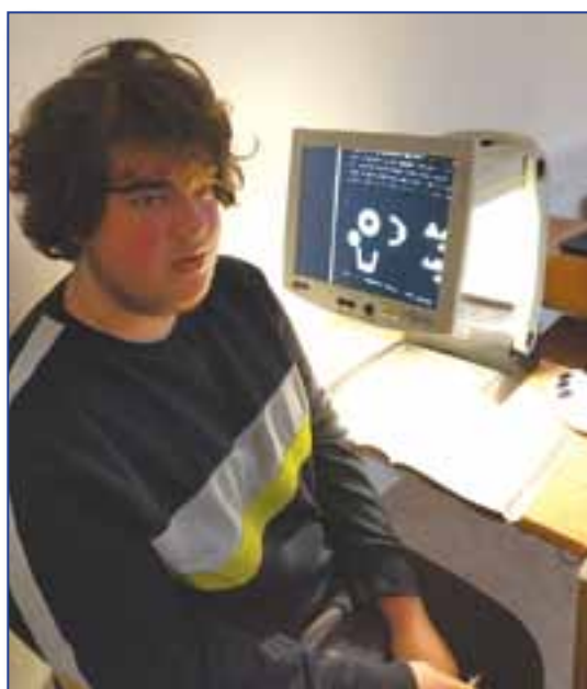
Elektronska lupa omogoča Aleksandru tudi spreminjanje kontrastov barv, da lahko bolj zaznava spremembe na predlogah.
