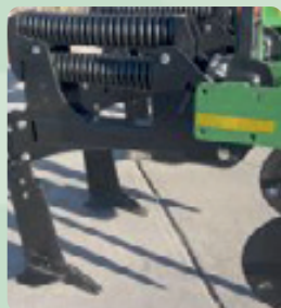
NOGAČE Z JEKLENO VZMETJO ZA SAMODEJNO PONASTAVITEV V PRIMERU PRISOTNOSTI OVIR V TALNIH PLASTEH
