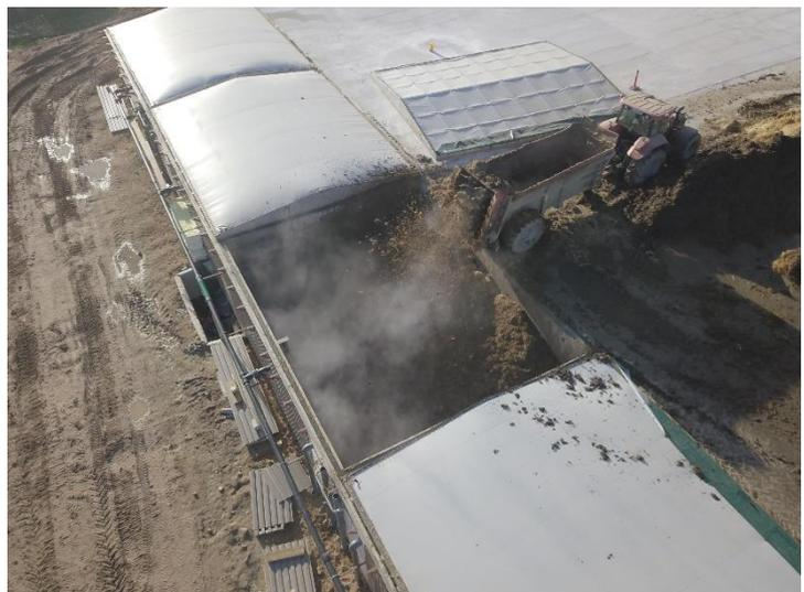
Figure 5 : Chargement d'un digesteur piscine (source Agri Synergie)
