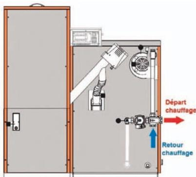
La conception du brûleur assure une combustion parfaite par gazéification et élimine tous polluants dans les fumées. L'échangeur tubulaire assure un rôle de récupération de calories pour contribuer au rendement de plus de 90% des chaudières GM EASY.
