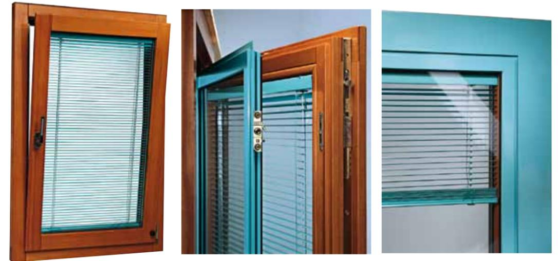
Il serramento mod. ATHENA 98 CLS si caratterizza per la presenza di un sistema oscurante tipo "veneziana" all'interno di un vano interposto tra il vetro-camera e il cover esterno in alluminio di copertura dell'anta. L'apertura del telaietto consente di accedere al suddetto vano per esigenze di pulizia e manutenzione dell'oscurante. La complanarità delle coperture esterne in alluminio e il profilo squadrato del legno conferiscono a questo modello un tocco di modernità e di design.
